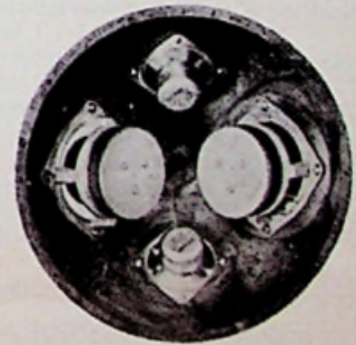
Stand 43 Bovema Nivico bolstraler geopend. Alleen in deze helft reeds 4 speakers, 8 stuks wordt het totaal, goed voor een vermogen van max. 80 watt.
