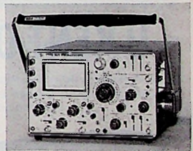
Type 454 / R 454 * Bandbreedte DC - 150 MHz Twee kanalen met elektronische omschakeling - Gevoeligheid: 5mV/sch.d. tot 10V/sch.d., DC- gekoppeld - Dubbele tijdbasis- generator met gecalibreerd sweep delay - Naversnellingspanning 14kV! - Voeding uit lichtnet - Afm. 18.4 x 30.8 x 52 cm; gew. ca. 13 kg
