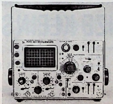
Type 453 / R 453 * Bandbreedte DC - 50 MHz Twee kanalen (FET-ingangen) met elektronische omschakeling Gevoeligheid: 5mV/sch.d. tot 10V/sch.d., DC-gekoppeld Dubbele tijdbasisgenerator met gecalibreerd sweep delay Voeding uit lichtnet - Afm. 18.4 x 30.8 x 52 cm; gew. ca. 13 kg
